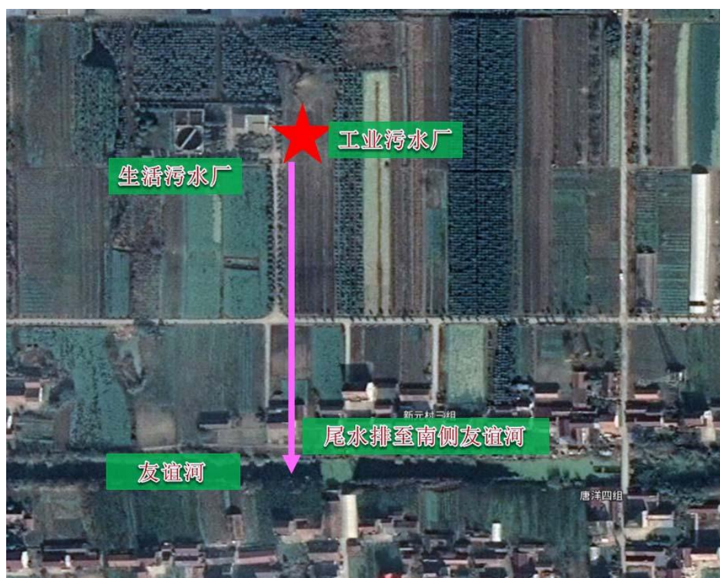
图 3.1-2 唐洋镇工业污水厂尾水排放示意图
