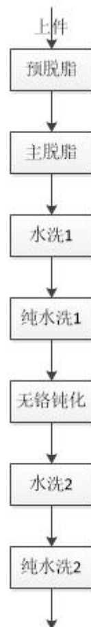
图 2-4 脱脂钝化详细工艺流程图
