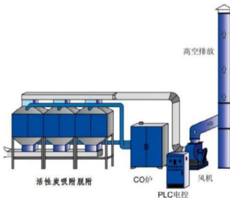
图 6.1-7 活性炭吸附装置结构图
