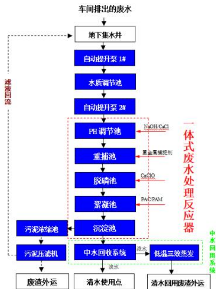
图 4-3 厂内污水处理站处理工艺流程图
