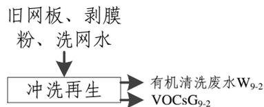
图 2-9b 网板翻新工艺流程图
